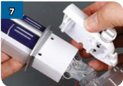
Возьмите деталь (LPL-03), с которой вы работали на этапе 43, и вставьте её установочные штифты в соответствующие отверстия опоры.
