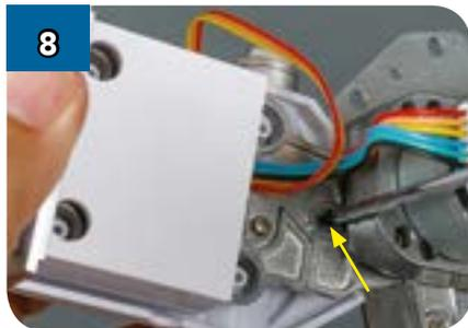
Закрепите установленную деталь, закрутив с обратной стороны опоры чёрный саморез 2,3 x 6 мм в указанное на фотографии отверстие.
