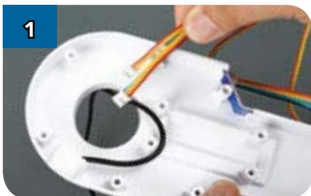
Пропустите концы проводов, которые вы только что проложили по каркасу левой опоры, в широкое отверстие детали (LPL-04), с которой вы работали на этапе 48.
