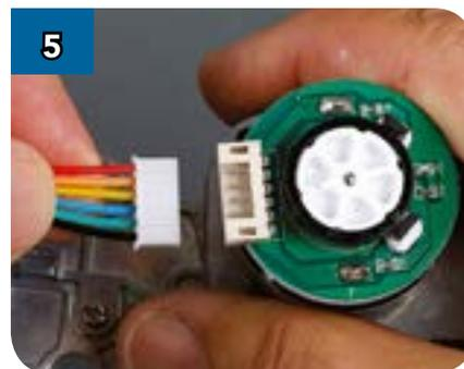
5 Возьмите жгут из шести проводов, который вы получили с выпуском 46, и вставьте его широкую вилку в разъём на печатной плате двигателя.
