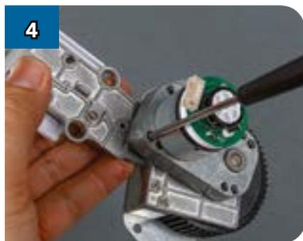
4 Вставьте по винту в каждое из четырёх отверстий по углам корпуса и закрутите их.
